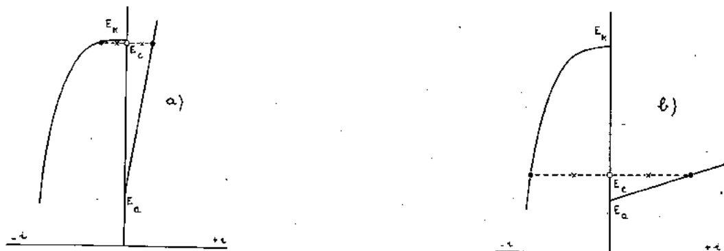
Fig. 7. — Evolution du potentiel d'un acier inoxydable se piquant au cours de l'immersion dans l'eau de mer.
