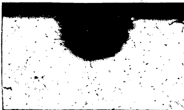
Fig. 9 : Morphologie de la dissolution de l'alliage A85. Coupe micrographique, attaque Keller (x 50)
